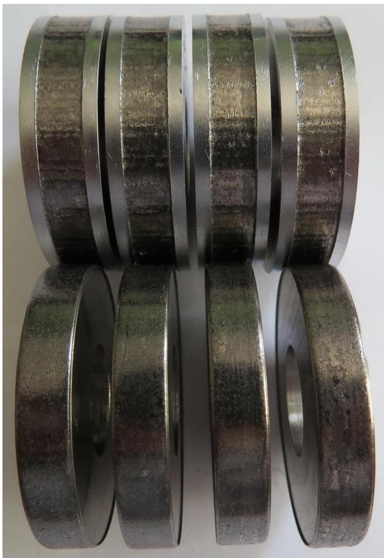
Рис. 11. Внешний вид поверхностей трения колесных роликов с композиционным покрытием (вверху) и ответных рельсовых контроликов (внизу) после завершения испытаний
