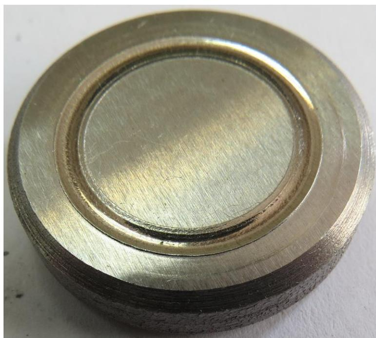
Рис. В.2. Образец из колеса без покрытия (№ 25), состояние после  $0,5 \times 10^6$  циклов испытания
