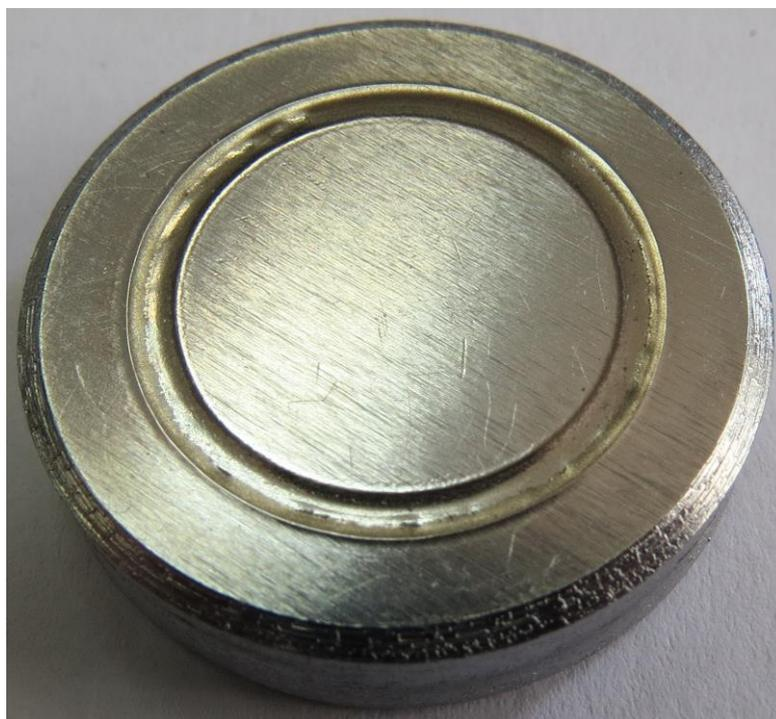
Рис. В.1. Образец из колеса с композиционным металлоалмазным покрытием (№ К23), состояние после  $0,5 \times 10^6$  циклов испытания
