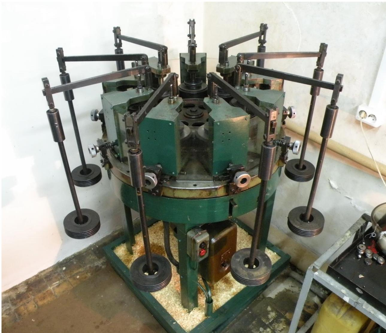
Рис. 15. Машина для испытания на контактно-усталостную выносливость
